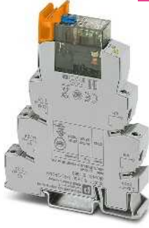
Kilitlenebilir manüel operasyonlu 2 enversör kontaklı röle modülü, maks. 2 x 50 mA
