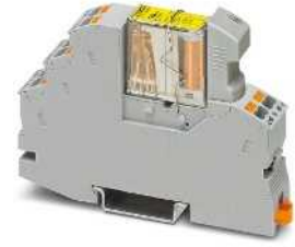
2-PDT röle modülü force-guided kontaklı, maks. 2 x 6 A
