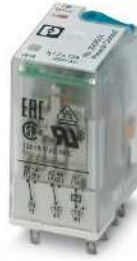
Manuel operasyonlu, 2 enversör kontaklı (polarizasyonsuz) endüstriyel röle, 2 x 12 A, maksimum
