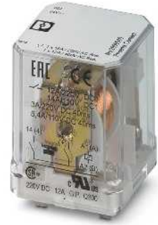
Yüksek DC yüklerini anahtarlama için mıknatıslı 1 N/O kontaklı yüksek güç rölesi
