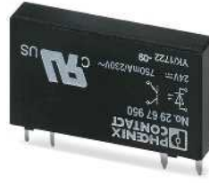
Solid-state röle AC çıkış maks. 750 mA
