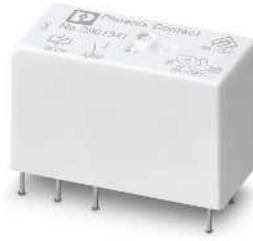
Yüksek kalkış akımları için 1 N/A kontaklı röle, 130 A tepe, maksimum
