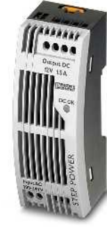
Güç kaynağı, 1 AC, 12 V DC, 1.5 A Yassı tasarım, NEC Class 2
