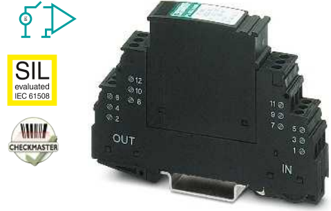
Ortak referans potansiyelli 4 tel, 9/10 bağlantısı gazlı arestör üzerinden topraklı, dijital sinyaller için
