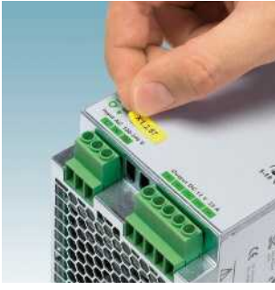
Rulo şeklinde yapışkanlı ekipman etiketleme malzemeleri, termal transfer rulo yazıcısıyla basılır EML... Sayfa 324
