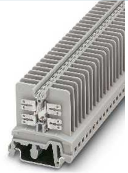
6 (6) mm 2 , 32 A, geçiş klemensi, yassı fiş bağlantılı
