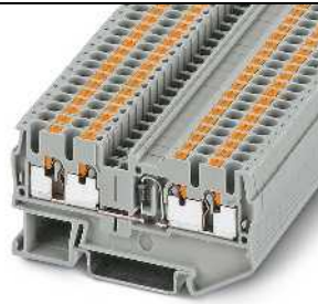
0.5 A, diyotlu klemens, 1N 4007 (1300 V/0.5 A), 4 bağlantı
