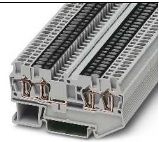
17.5 A, geçiş klemensi, 4 bağlantı, kesintili akım barası
