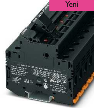
25 (25) mm 2 , 32 A, 1000 V, kollu sigortalı klemens, 10.3 x 38 mm mini sigortalar için
