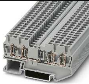
0.5 A, diyotlu klemens, 1N 4007 (1300 V/0.5 A), 4 bağlantı
