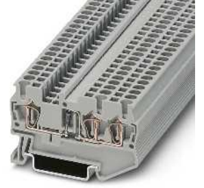
0.5 A, diyotlu klemens, 1N 4007 (1300 V/0.5 A), 3 bağlantı
