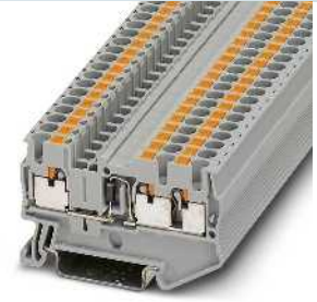
0.5 A, diyotlu klemens, 1N 4007 (1300 V/0.5 A), 3 bağlantı
