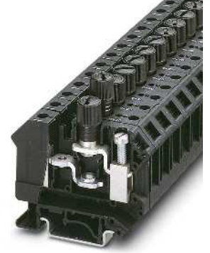
16 (16) mm 2 , 10 A, sigortalı klemens, 5 x 20 mm tipi kartuş sigortalar için
