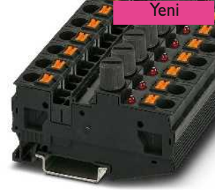
10 A, sigortalı klemens, 5 x 20 mm tipi kartuş sigortalar için, LED'li
