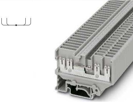
6 (6) mm 2 , 32 A, geçiş klemensi, yassı fiş bağlantılı
