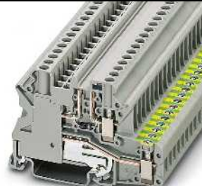
0.5 A, diyotlu klemens, 1N 4007 (1300 V/0.5 A), iletim yönü: soldan sağa doğru
