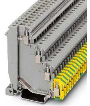
2.5 (4) mm 2 , 26 A, PE ayaklı dört iletkenli aktüatör klemensi
