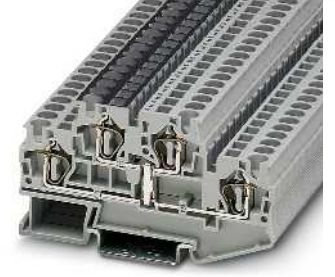
32 A, çift katlı klemens, eşpotansiyel bağlantılı
