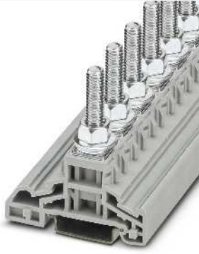
50 (50) mm 2 , 150 A, M8 cıvata bağlantılı klemens
